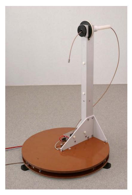
Vorrichtung zum ferngesteuerten Positionieren von Prüflingen und Sonden um zwei Achsen. Das Objekt befindet sich im Schnittpunkt einer senkrechten Achse (Azimuth) mit einer waagerechten Achse (Höhe).
